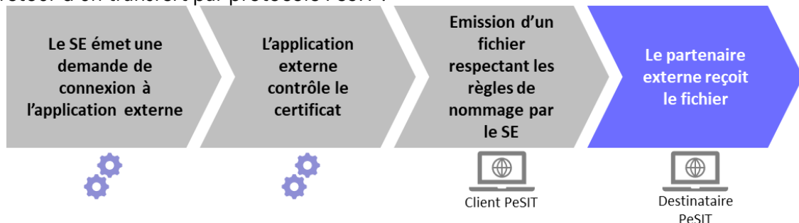
Figure 44 : Schéma d'un circuit retour d'un transfert par protocole PeSIT
