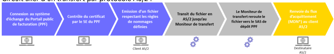
Figure 47 : Schéma d'un circuit aller d'un transfert par protocole AS/2
